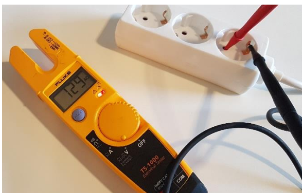
Måling av linjespenning (233 V), og de to fasespenningene (139 og 129 V) i et grenuttak. Friskt nett uten jordfeil.
