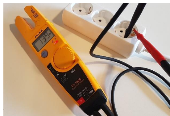
Måling av linjespenning (233 V), og de to fasespenningene (139 og 129 V) i et grenuttak. Friskt nett uten jordfeil.
